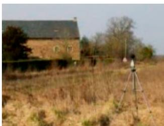
Mesure de bruit à proximité d'une habitation au moyen d'un sonomètre
